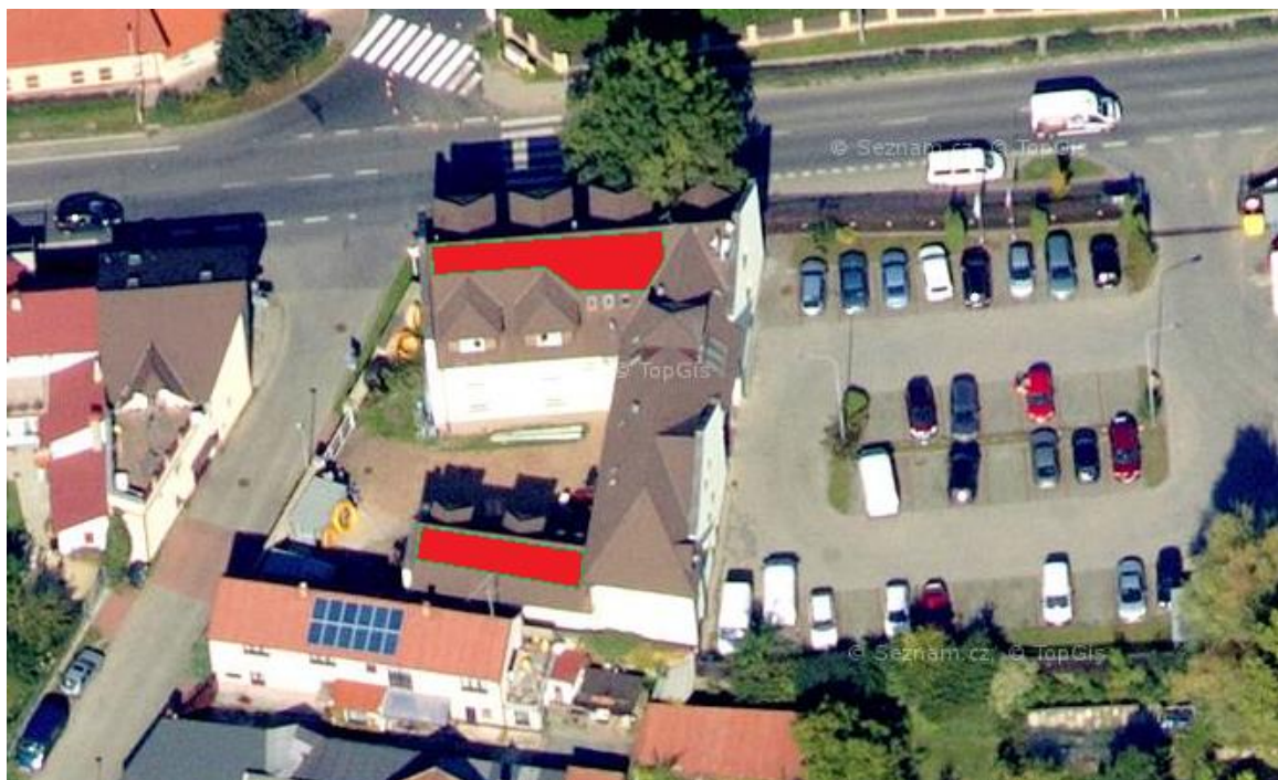
Obrázek 25 Umístění fotovoltaických panelů
